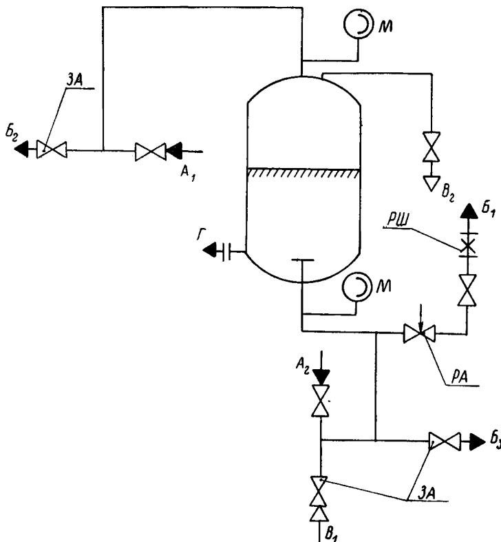
$A_1$  — вход обрабатываемой воды;  $A_2$  — вход промывочной воды;
